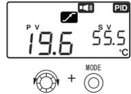
ジョグスイッチ(回転)とMODEキー(桁選択)で、設定温度(SV)を入力してください。
