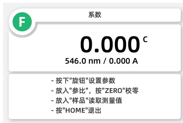
图 6-9 输入标准曲线方程的斜率 K 和截距 B, 测量未知样品浓度
