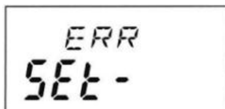
图（1）节流孔板探测错误
