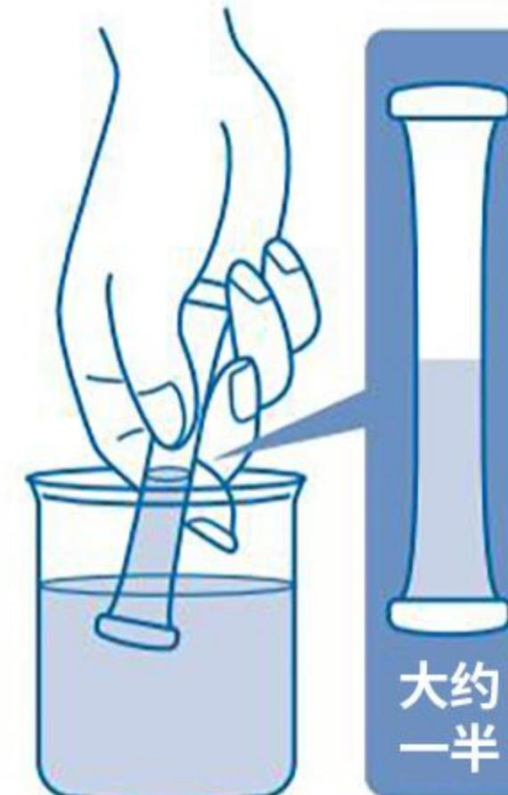
③ 将其按原样直接放入测试水中, 松开捏着的手指, 等它吸收一半的水。轻轻摇晃试管5~6次以防止泄漏
