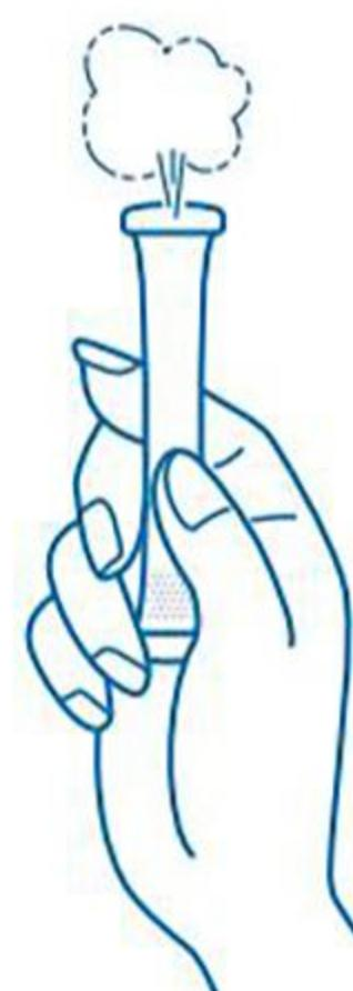
② 洞口向上, 用手指紧捏住管子的下半部排出内部的空气
